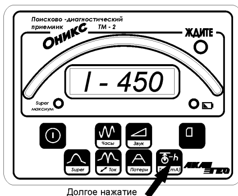
Рис 3.5.1. Отображение информации в режиме измерения тока
