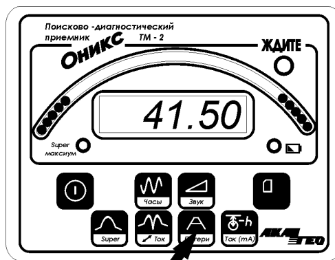
Рис 3.5.2. Отображение информации в режиме электро измерений придвижении оператора от генератора. Указание НАЗАД.
